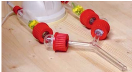
Abb. 2: Ein Olfaktometer ist eine Laboreinrichtung, in der Insekten gegen einen leichten Luftstrom auf zwei unterschiedliche Duftquellen zulaufen und an der Abzweigung einen Duftstoff «wählen» können.
