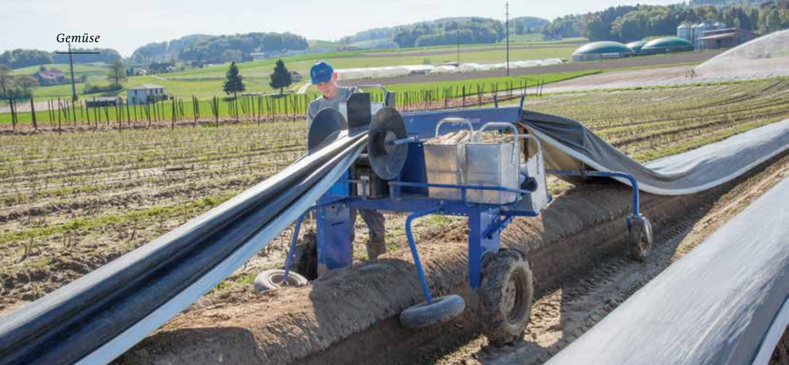
Die elektrische Spargelspinne hebt das Vlies an und macht den Damm frei, um die weissen Spargeln zu stechen. Bilder: David Eppenberger
