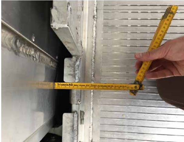
Spalten zwischen höhenverstellbaren Ladeböden und der Fahrzeugwand stellen eine Verletzungsgefahr dar.
