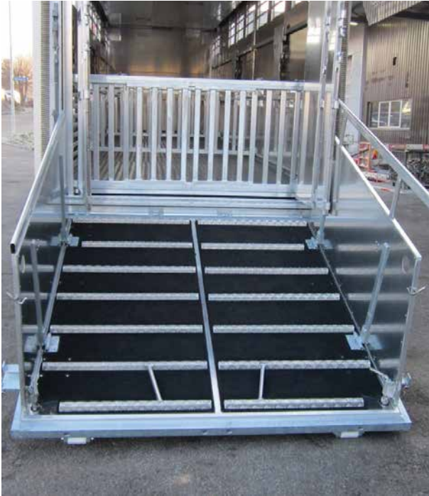
Eine gut eingerichtete Rampe mit Seitenschutzvorrichtung, trittsicherem Boden und ohne Spalten erleichtert das tierschonende Ver- und Entladen.
