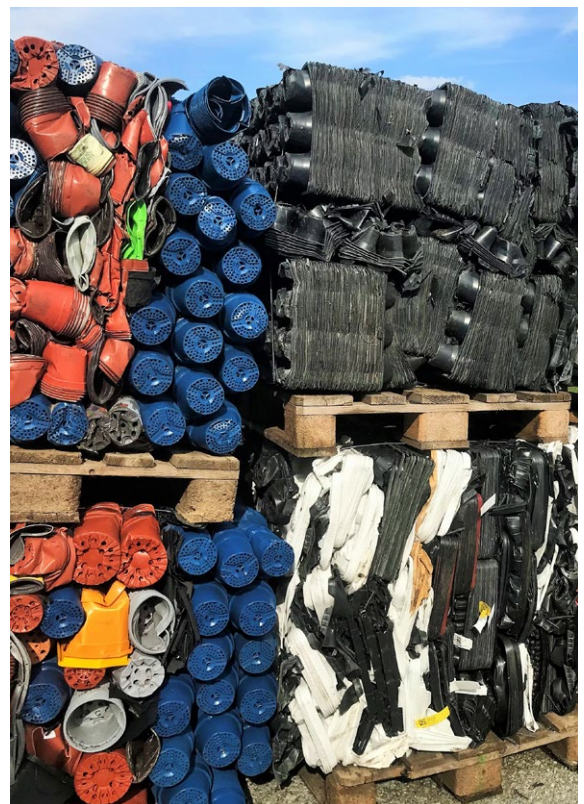
Töpfe, Trays und andere recycelbare Entsorgungsgüter werden für die Lagerung beim Topfpflanzenproduzenten und den Transport zum Kunststoffrecycling-Werk zu Ballen gepresst. Das benötigt dreimal weniger Platz und spart Transportkosten.
