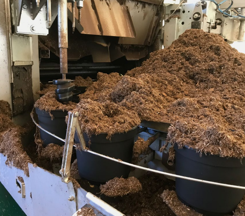
Töpfe werden maschinell mit torfreduziertem Baumschulsubstrat befüllt.
