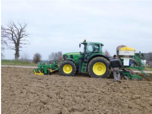
Abbildung 1: Saat der Versuchsstreifen ohne vorgängige Saatbettvorbereitung der gepflügten Parzelle mit einer Direktsaatmaschine. Davon erhofft man sich eine genügend tiefe Saatgutablage sowie einen Beitrag zur Vermeidung von Erosionsschäden. Givisiez FR, 23.03.2016
