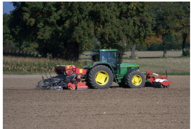
Abbildung 2: Saat von Mischkulturen mit einer üblichen Sämaschinenkombination
