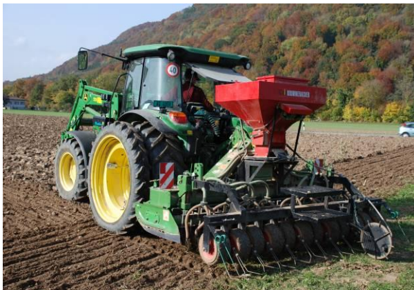
Abbildung 1: Saat von Mischkulturen mit einem Krummenacher Sägerät
