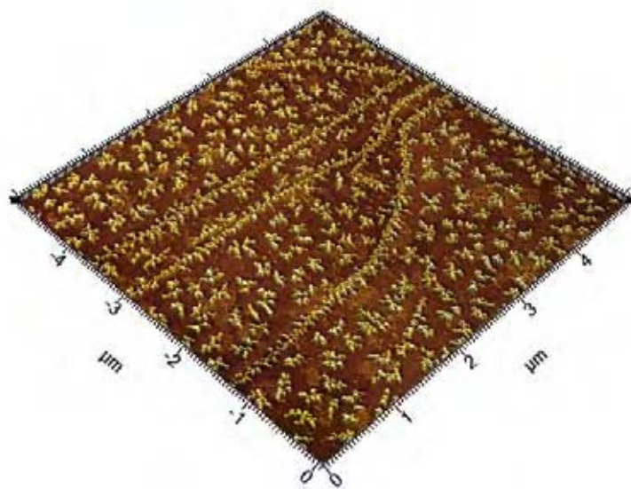
Rasterkraftmikroskopische Aufnahme von Nanosilber auf einer Graphitoberfläche. Die Partikel, bestehend aus einigen Hundert Silberatomen, werden wegen ihrer antibakteriellen Wirkung in Desinfektionsmitteln und in einigen europäischen Ländern, nicht aber in der Schweiz, auch in Verpackungen eingesetzt. Der Durchmesser dieser Partikel beträgt etwa 50 Nanometer.
