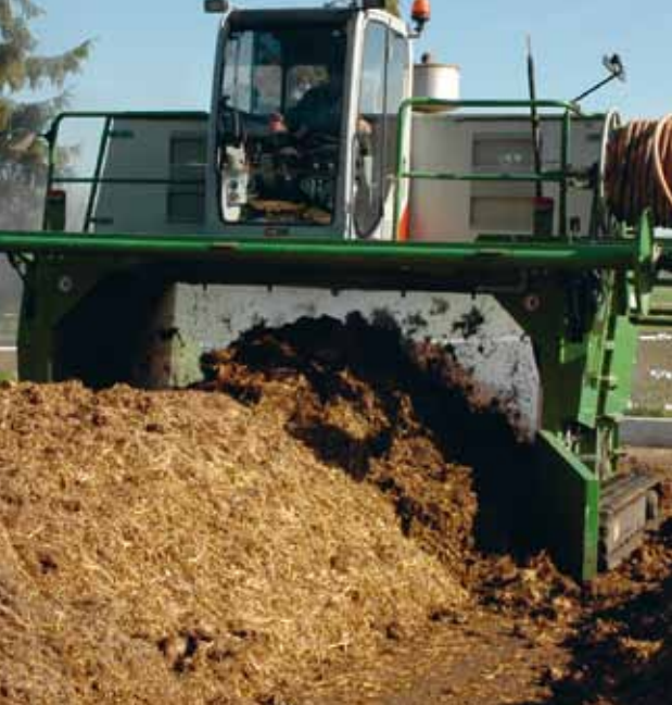
Der Umsetzer bringt Sauerstoff in den Mist und durch Kleinlebewesen zersetzt sich das Stroh rasch.
