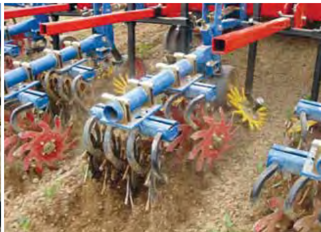
Die Sternhacke lässt sich beim Weghäufeln mit der Fingerhacke kombinieren.
