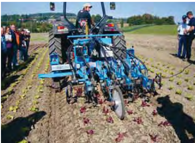
Die Selektivhacke (bisher nur für Salate entwickelt, ca. 60'000 Euro) kann die Handarbeit in den Reihen übernehmen. Die Kulturpflanze wird digital erfasst (Robovator; Vertretung Fobro-Kress).
