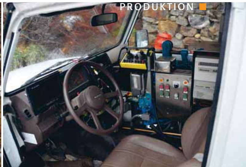
Einen Teil der Arbeiten soll Jacques Granges aus dem auf Elektroantrieb umgebauten Geländewagen erledigen können.
