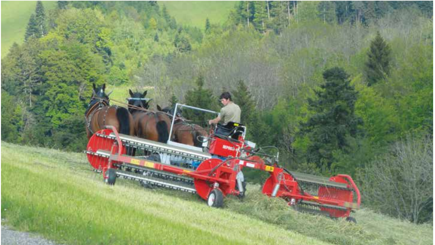
David Michel mit seinem Heuschwader: Die Maschine wird via die Räder des Vorderwagens und eine Hydraulikpumpe angetrieben.
