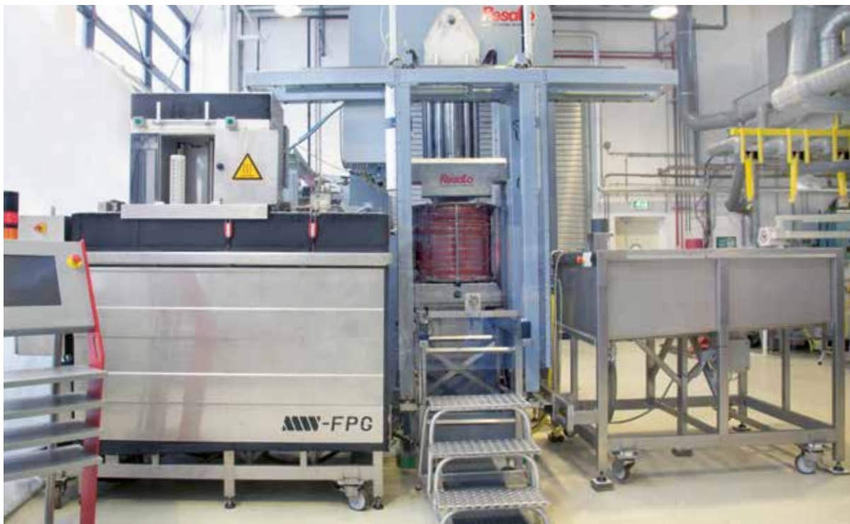
Pilotanlage für Hochdruckkonservierung an der holländischen Universität Wageningen (WUR). Bild: Ariette Matser, WUR
