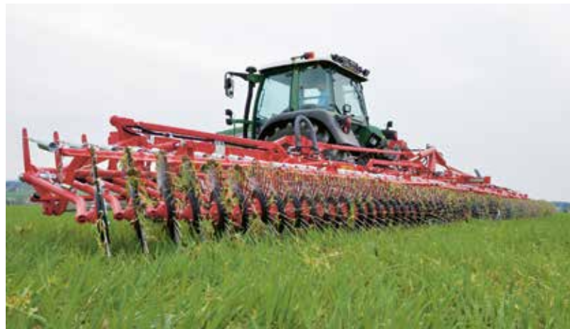
Der Rotorstriegel Aerostar soll besonders wenig verstopfen.
