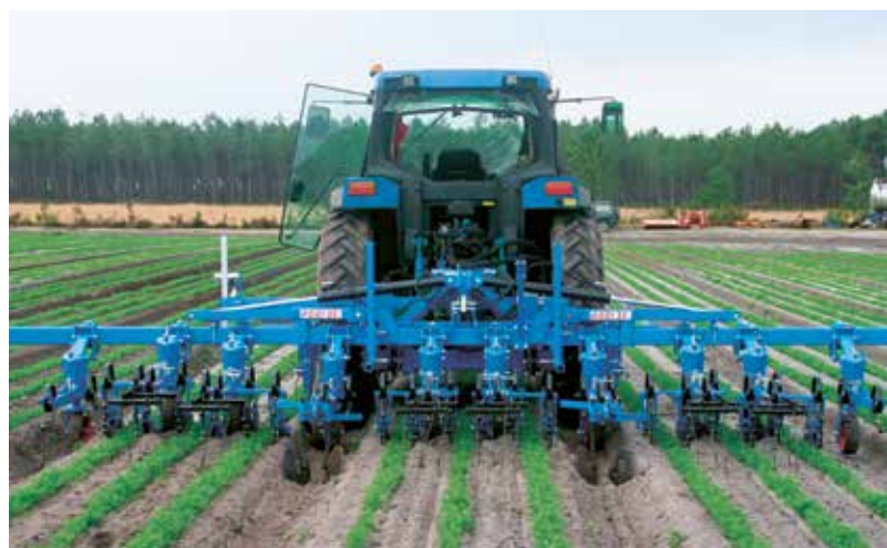
Das Kameralenksystem Précicam von Carré soll eine Arbeitskraft bei der Reihenlenkung einsparen.
