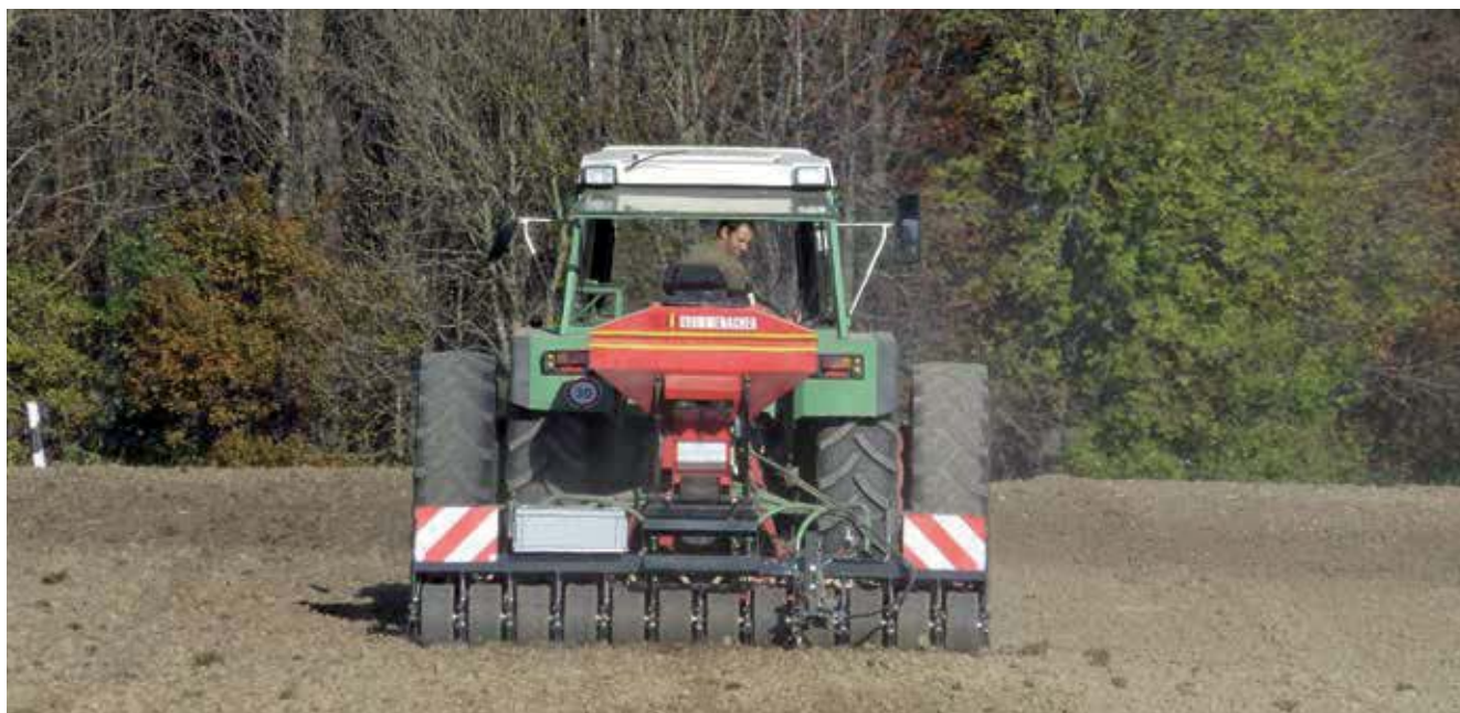
Weizen sät Urs Knecht mit einer Säkombination aus einer Kreiselegge und einer Krummenacher-Säwalze. Beide Geräte sind sehr leicht, sodass er diese Kombination auch mit seinem 85-PS-Traktor bedienen kann. Bild: Strickhhof
