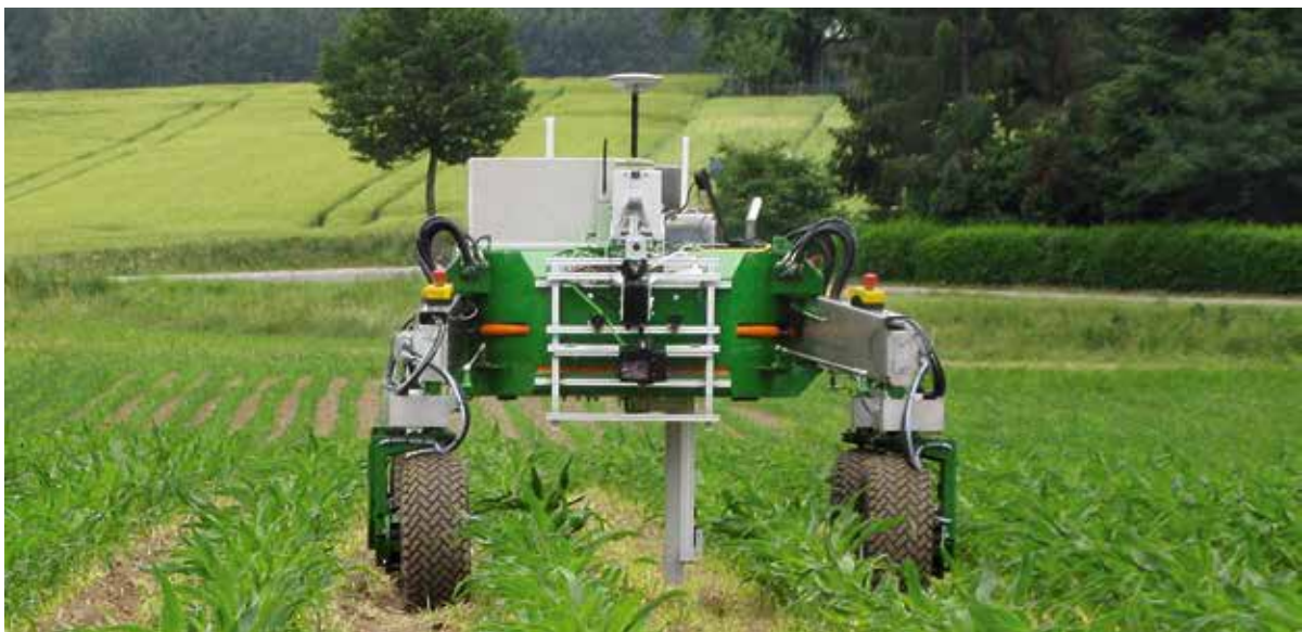
Der BoniRob, entwickelt von den Firmen Bosch und Amazone, soll dereinst die Beikräuter mit einem Bolzen in den Boden drücken. Das Gerät ist aber noch nicht praxistauglich. Bild: Amazone
