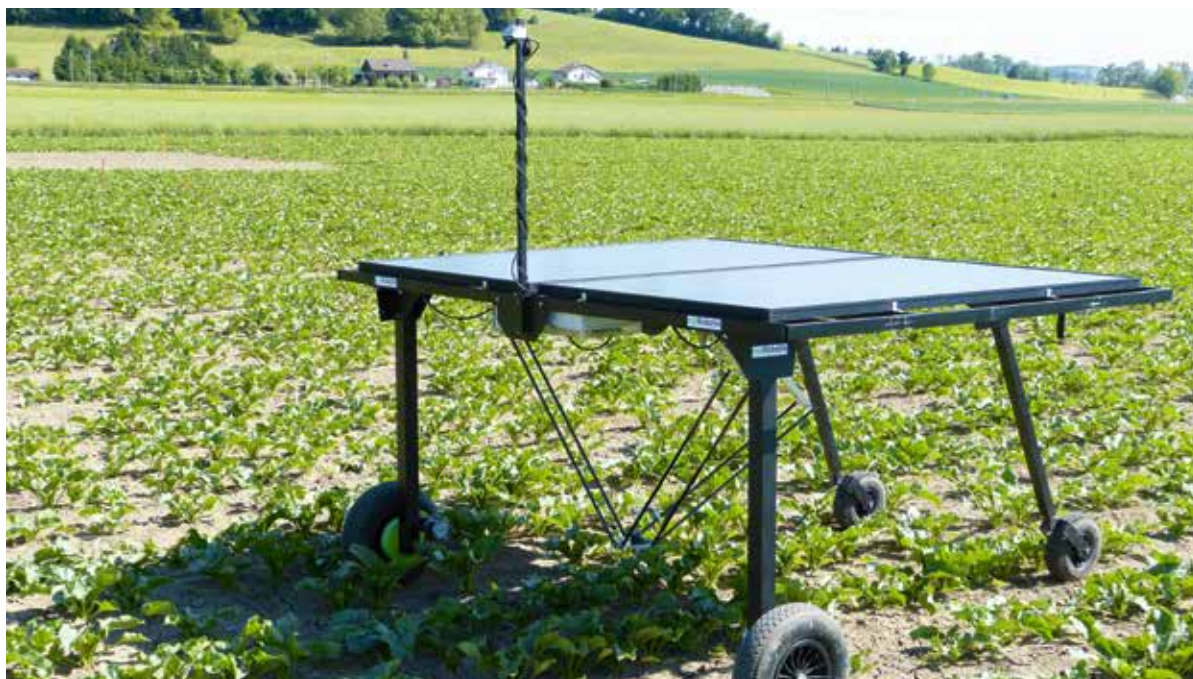
Der solarbetriebene Jätroboter von ecoRobotix mit Herbizidspritze in den Zuckerrüben. Bild: ecoRobotix
