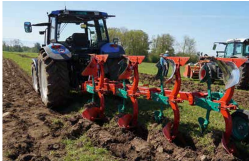
Mit einem gut eingestellten konventionellen Pflug kann man sauber oberflächlich pflügen. Bilder: Thomas Alfeldi
