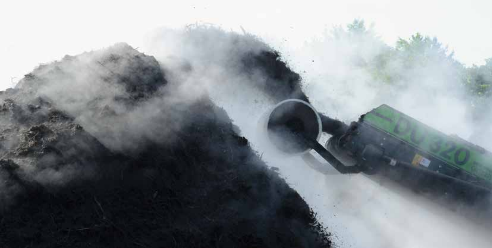
Die Kompostieranlagen verfügen über leistungsstarke Maschinen zum Umsetzen der Mieten. Bild: Jacques Fuchs, FiBL
