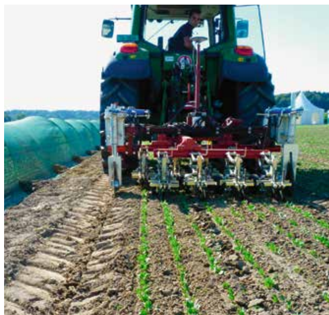
Satellitenbasiertes System, das mit Scheibensechen angesteuert wird.
