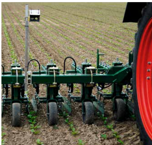
Kameragelenkte Hackgeräte sind flexibel einsetzbar.
