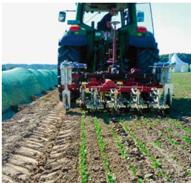
Satellitenbasiertes System, das mit Scheibensechen angesteuert wird.
