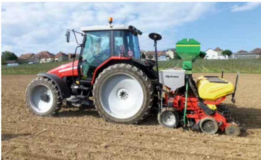
Dieser Prototyp wurde von Maurice Clerc, FiBL, für den Sojaanbau entworfen und von der Firma Alphatec gebaut. Dank der Kombination einer Exaktsämaschine (Soja) mit einer Drillmaschine (Untersaat) kann die Untersaat präzise eingesät werden. Bilder: Maurice Clerc
