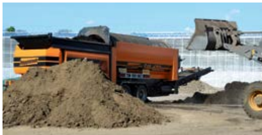
Kompost-Siebmaschine im Einsatz.
