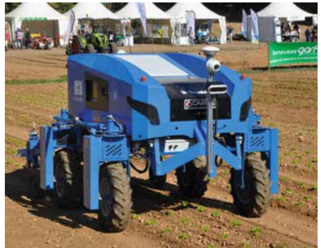
Zweiter Prototyp des Unkrautroboters «Anatis»: 800 sensorbepackte Kilo.
