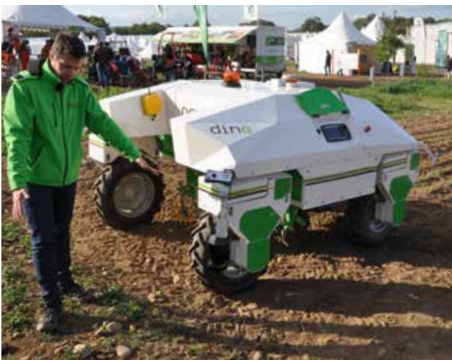
Gemüsejätroboter-Prototyp «Dino»: 400 kg schwer, 3 bis 4 km/h schnell.
