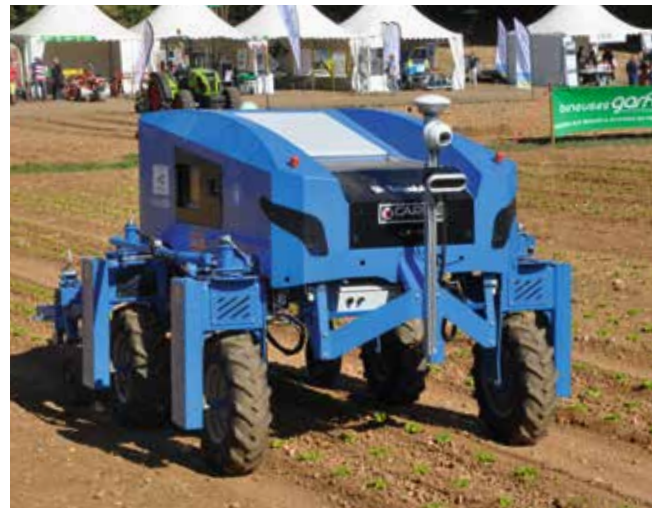
Zweiter Prototyp des Unkrautroboters «Anatis»: 800 sensorbepackte Kilo.
