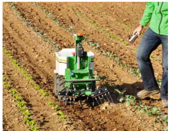
Im Handel: «Oz», 150 kg, 1,3 km/h Arbeitsgeschwindigkeit. Bilder: hir
