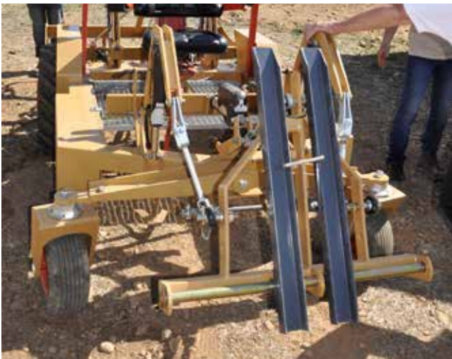
Elektrotraktor-Prototyp «Alpo» mit 25 PS Stärke und 450 kg Gewicht.
