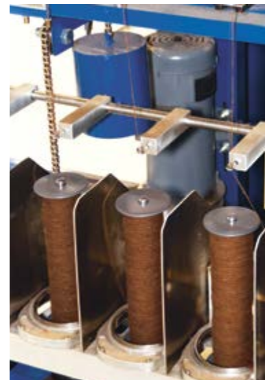
Die Spinnmaschine verdreht die Wollfasern zu einem Garn.
