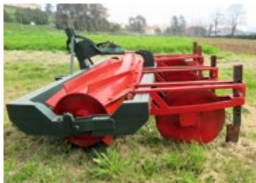
Prototyp einer Messerwalze, die auch Pflanzschlitze zieht.
