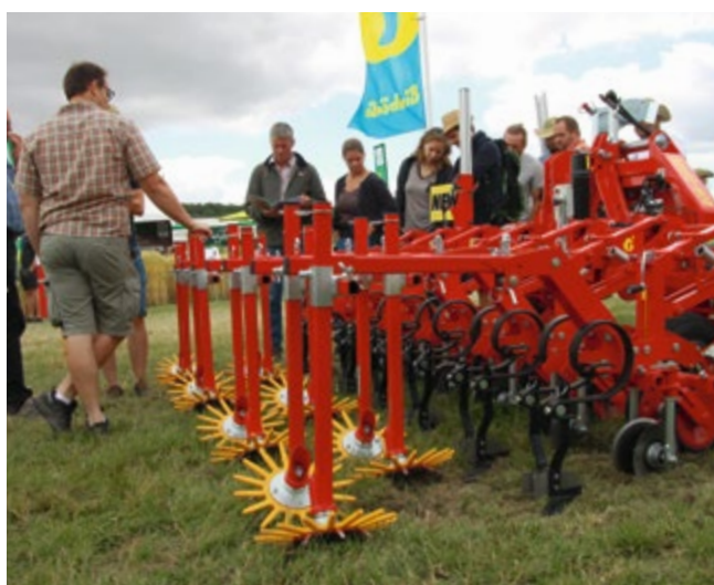
Eine der vorgestellten Innovationen: Die Tellerhacke Chopstar Twin wurde für das Hacken von Unkräutern in Mulchbeständen entwickelt. Bild: Claudia Frick
