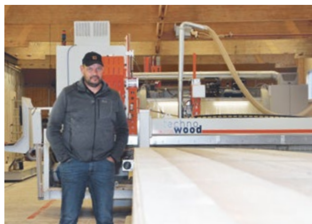
Jürg Hirschi vor seiner Fertigungsstrasse, die bis zu 24 Zentimeter dicke Sperrholzplatten verdübelt. Bild: Stephan Jaun
