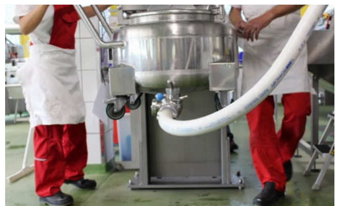
Die Konfitüre wird über einen Schlauch in die Abfüllanlage eingespiessen.
