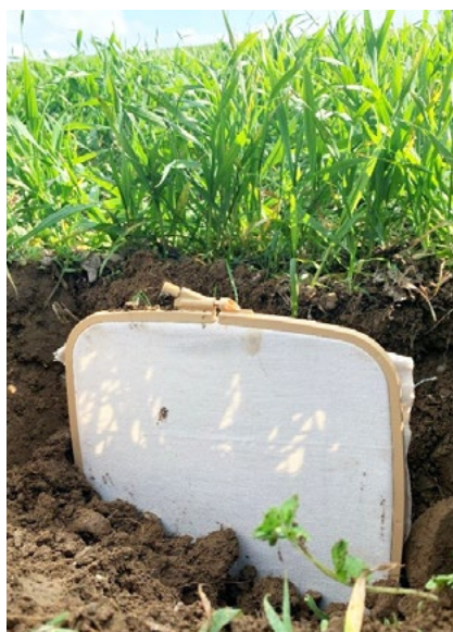
Die Stickrahmen mit Biobaumwolltüchern werden im Frühling vergraben und während 60 Tagen im Boden belassen. Das Ergebnis ist danach direkt sichtbar: Je weniger Stoff übrig bleibt, desto höher ist die Abbaurate. Bilder: Jeremias Niggli, FiBL
