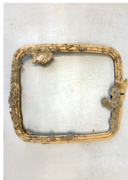
Die Stickrahmen mit Biobaumwolltüchern werden im Frühling vergraben und während 60 Tagen im Boden belassen. Das Ergebnis ist danach direkt sichtbar: Je weniger Stoff übrig bleibt, desto höher ist die Abbaurate. Bilder: Jeremias Niggli, FiBL
