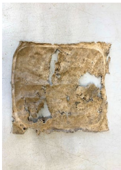
Die Stickrahmen mit Biobaumwolltüchern werden im Frühling vergraben und während 60 Tagen im Boden belassen. Das Ergebnis ist danach direkt sichtbar: Je weniger Stoff übrig bleibt, desto höher ist die Abbaurate. Bilder: Jeremias Niggli, FiBL
