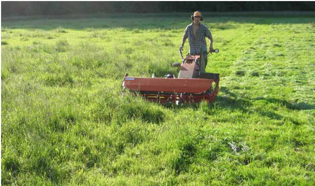
Auf dem Betrieb von Niklaus Daepf werden die Weiden mit erhöhtem Messerbalken gemäht (siehe Kurztexzt letzte Spalte). Bild: Niklaus Messerli
