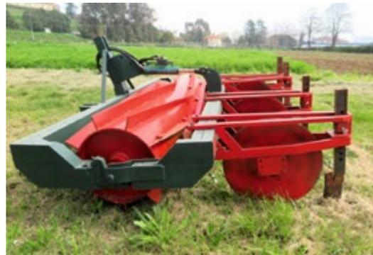
Prototyp einer Messerwalze, die auch Pflanzschlitze zieht.
